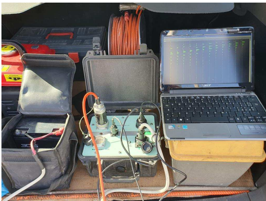
Foto 3 -Sismografo 24 canali Pasi mod. 16S24-U
