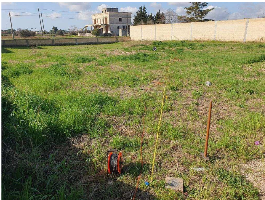
Foto 2 -Esecuzione sondaggio sismico MASW
